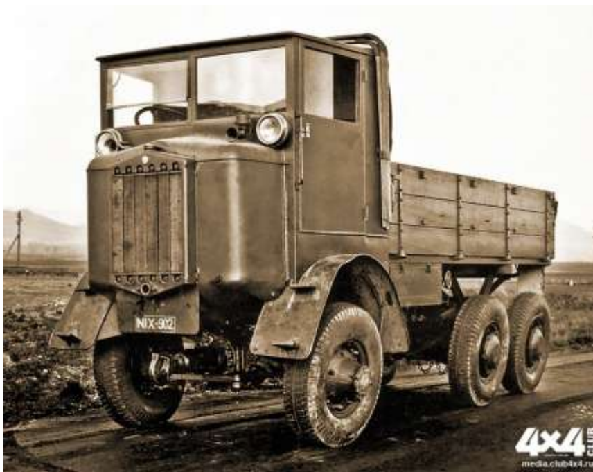
Tatra T25. Опытный полноприводный T25 (1926) оснащался 4-цилиндровым бензиновым мотором (7,5 л, 65 л. с.) Создатель Tatra. Ганс Ледвинка (1878–1967)
